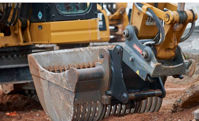
Der Wechsel von Anbauteilen mit OilQuick ist fast so schnell wie ein Formel-1-Boxenstopp, in wenigen Sekunden ist alles erledigt und die Arbeit kann fortgesetzt werden.
