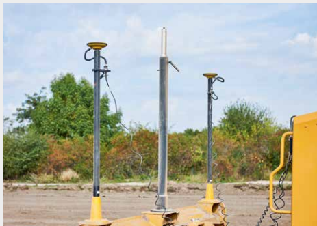
Am Schild des Graders angebrachte Masten empfangen die Positionssignale des Tachymeters.
