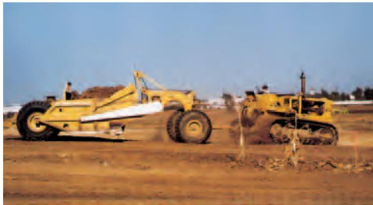
Schon sehr lange arbeitet Michel Bau mit den zuverlässigen und robusten Baumaschinen der Weltmarke Caterpillar. Die D8, ein schwerer Traktor mit Kettenlaufwerk und Anhängeschürfkübel, der zur Bearbeitung von großen Flächen eingesetzt wird, ist in Deutschland eine echte Seltenheit. Die Marke Caterpillar wird übrigens seit über 50 Jahren vom deutschen Weltunternehmen Zeppelin vertrieben.
